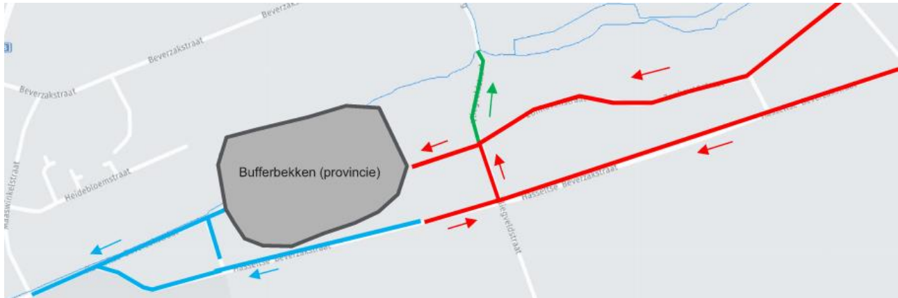
Figuur 11: Opdeling afwatering RWA
